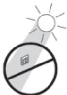
Platzieren Sie den Thermostaten so, dass dieser nicht dem direkten Sonnenlicht ausgesetzt ist.
