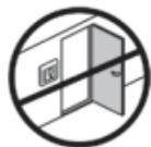
Um Zugluft zu vermeiden, bringen Sie den Thermostaten stets in einem Abstand von mindestens 50 cm zu Fenstern und Türen an, wenn Sie ihn zur Regelung der Raum- und Bodentemperatur oder ausschließlich zur Raumtemperaturregelung verwenden.
