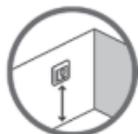
Platzieren Sie den Thermostaten in geeigneter Höhe an der Wand (ca. 80-170 cm).
