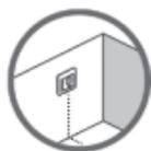
**Hinweis:** Ein Bodenfühler wird für alle Fußbodenheizungen empfohlen und ist in Verbindung mit Dünnbettheizmatten und unter Holzböden vorgeschrieben, um das Risiko einer Überhitzung des Fußbodens zu verringern.
