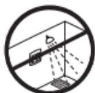
Der Thermostat darf nicht in feuchten Räumen angebracht werden. Der Thermostat muss außerhalb von Zone 3 platziert werden. Platzieren Sie ihn in diesem Fall in einem angrenzenden Raum und verwenden Sie ausschließlich den Bodenfühler. Platzieren Sie den Thermostaten stets gemäß den lokalen IP-Schutzartvorschriften.
