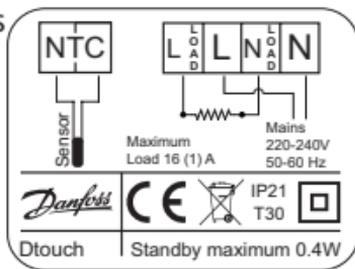
**Hinweis:** Installieren Sie den Bodenfühler stets in einem Leerrohr im Boden.
